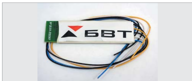
Рис. 5. Электронный адресный селективный переключатель АСИ типа SFS
